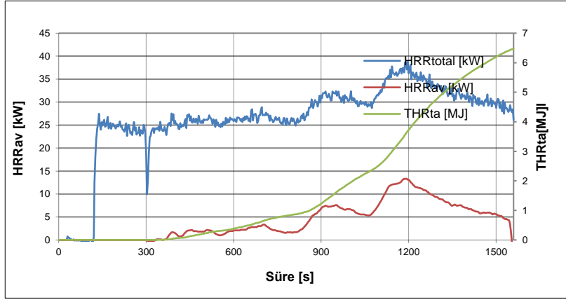
Şekil 7. Numune 3 için HRRav(t) , HRRav-30s ve THR değerlerinin grafiği
